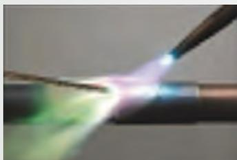
5. - Quando entrambe le parti hanno raggiunto la temperatura di brasatura si potrà introdurre la lega di apporto nella giunzione tra il tubo e il raccordo.
