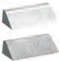
**BUONA QUALITÀ** – Il margine superiore è eccellente e la superficie di taglio levigata. Le scorie dovrebbero essere assenti o di facile rimozione e la sezione di taglio accurata. La velocità di taglio è più lenta del taglio verticale, perché l'effetto del pre-riscaldamento in parte non si riflette sulla piastra.
