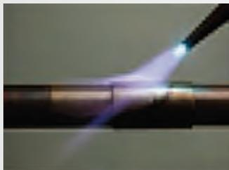
3. - Durante l'operazione, mantenere la fiamma con movimento oscillatorio su tutto l'assemblato, mantenendo uniforme il calore in entrambe le parti, fino a raggiungere la corretta temperatura di brasatura.
