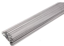
Bacchetta per saldatura TIG di acciai INOX (316, 316L, etc) stabilizzati o non. Temperature di esercizio -120°C +400°C. Utilizzata in chimico e petrolchimico, raffinerie, industrie alimentari.
