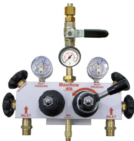
Quadro di decompressione a scambio automatico (riarmo manuale) per gas compressi (no acetilene) con pressioni fino a 300 bar. È possibile avere in opzione anche i manometri a contatto per ottenere il segnale a distanza di "gas in esaurimento".
