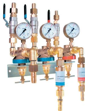
I posti presa ad alta portata S100 vengono anche forniti in versione tripla con due riduttori ossigeno e uno acetilene (o propano). Lo scopo è di avere due regolazioni indipendenti per l'ossigeno (una per il preriscaldamento e una per il taglio) e una per il gas combustibile quando si effettua ad esempio taglio automatico con pantografo.
