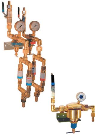
Si tratta della combinazione di una doppia postazione monoblocco di secondo stadio S100 (100m<sup>3</sup>/h) per quanto riguarda i gas OX+AC oppure OX+GPL destinati al riscaldamento (laddove una portata superiore ai 100 m<sup>3</sup>/h non servirebbe) con doppia valvola di sicurezza in uscita che aumenta la portata rispetto alla soluzione S100 standard.
