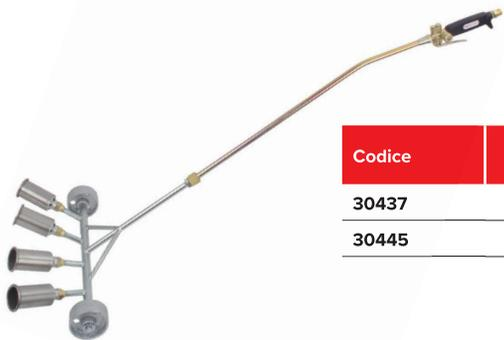
Set completo di impugnatura a leva lancia da 650 mm e rampa finale con 4 o 7 bruciatori da 45 mm. Per uso prolungato (grandi superfici) mettere 3 bombole di GPL da 15 kg circa in batteria.
