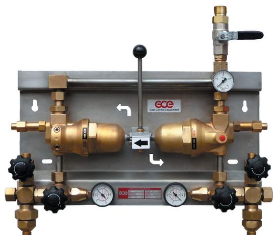
Il quadro di decompressione MS400 a scambio automatico (riarmo manuale) è montato su un pannello in acciaio inossidabile e composto da due riduttori a singolo stadio ad altissima erogazione con manometro di alta pressione su entrambi i lati e unico manometro di bassa pressione in uscita.
