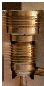
Dettaglio otturatore rotante
