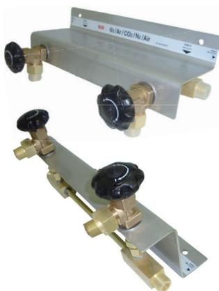
Le rampe a due posti sono l'ideale per fissare a parete in modo stabile un riduttore forte erogazione ed avere anche due ingressi separati con cui ottenere un sistema di riserva gas collegando (ad esempio) un pacco bombole all'ingresso 1 e una bombola all'ingresso 2 da attivare durante il cambio pacco non avendo così nessuna interruzione dei processi lavorativi. Si può naturalmente collegare la rampa anche a un quadro di decompressione a uno o due ingressi tramite un tubo flessibile.
